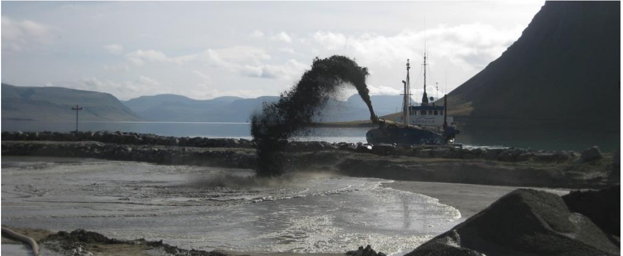
Mynd 4.8 Dæling kalkpörungasetts í hráefnislón verksmiðjunnar á Bíldudal. Mynd fengin af heimasíðu Íslenska kalkpörungafélagsins.
